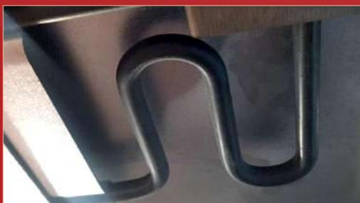
Le resistenze elettriche «a zig-zag» all'ingresso del forno impediscono la dispersione del calore e garantiscono una cottura uniforme, senza bisogno di girare le teglie durante la cottura.
