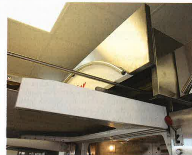
La façade de la hotte se soulève afin que l'enfourneur puisse atteindre sa position haute de rangement.
