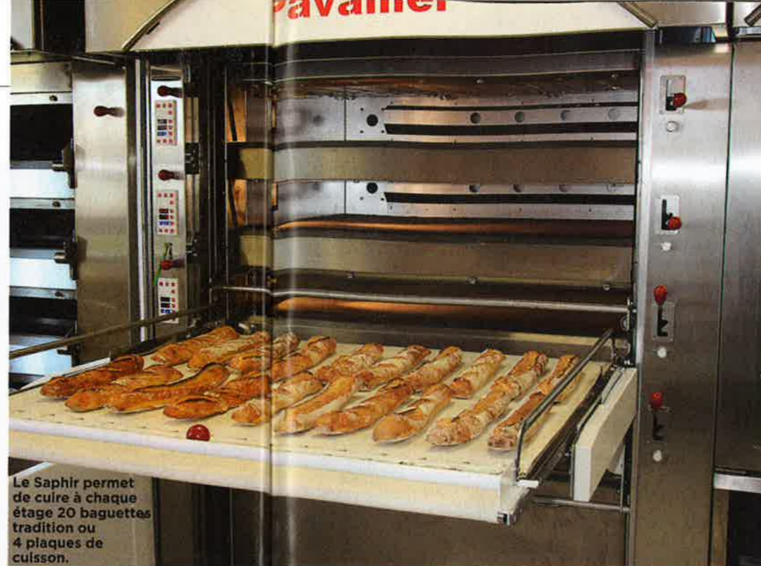
La maintenance se fait intégralement par la façade (à droite : l'appareil à buée).
