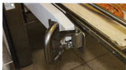
La nouvelle poignée ergonomique permet de positionner l'élevateur avec précision.
